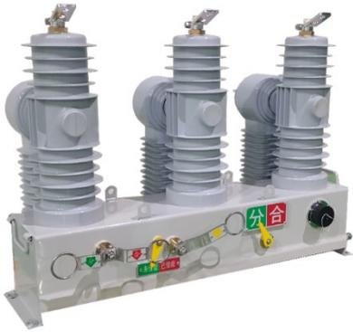
ZW32-12 型户外柱上真空断路器（普通融合型），完全符合国网一二次融合柱上断路器（支柱式）标准化设计方案要求，主要用于交流 50Hz 的三相 12kV 电力系统，用作 12kV 电力线路分段和联络开关，线路用户“T”接处分界用，配套符合国网标准化设计方案的配电自动化终端（FTU）；具备分、合负荷电流、过载电流、短路电流及小电流接地保护之用。
